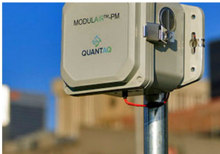
Sensor de calidad de aire de bajo coste. Modulair, Quantaq
