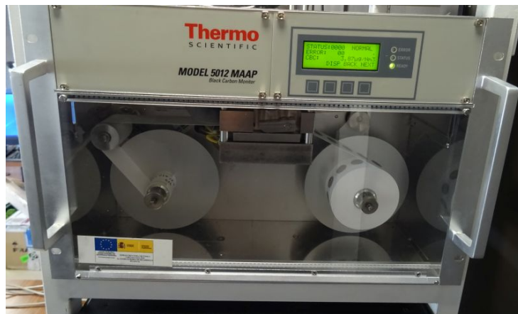
Fotómetro de absorción multi-ángulo (MAAP)
