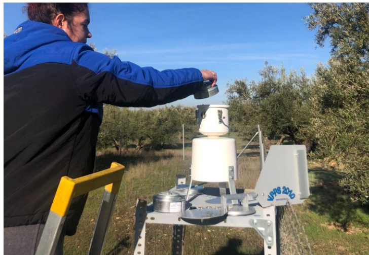
Captadores volumétricos tipo HIRST (Lanzoni)
